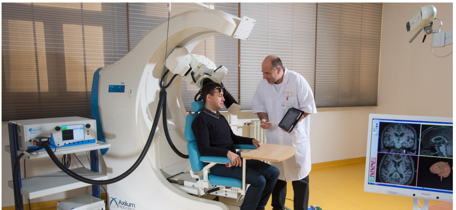
Le système de TMS robotisé et guidé par IRM mis en œuvre au CEMNIS
